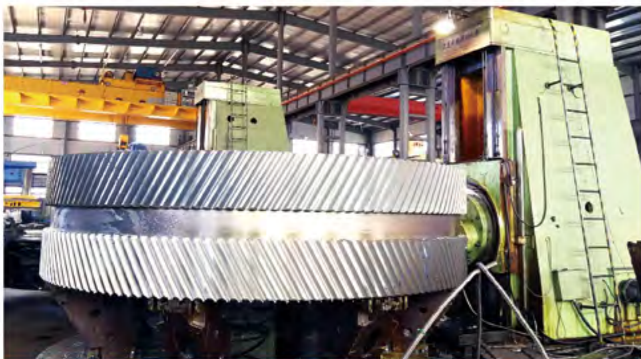
8米、14米滚齿机 直径: 8m、14米 模数: 40、50 8m, 14m Gear Hobbing Machine Diameter: 8m, 14m Module: 40, 50
