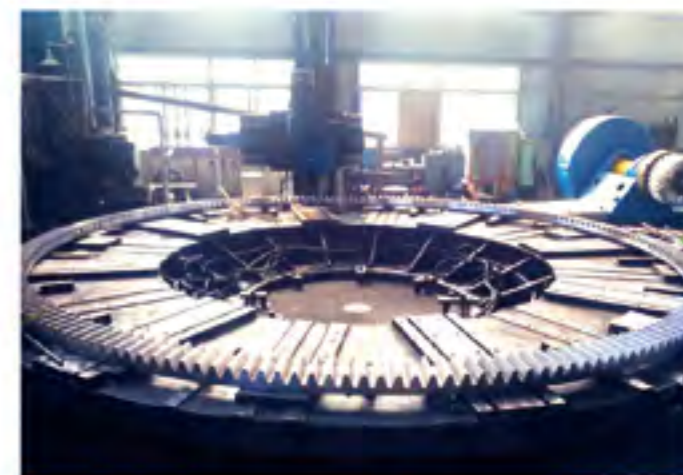
14米铣齿机 模数40 14m Gear Milling Machine Max. Module: 40
