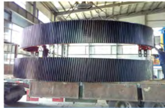
二分齿/ Girth Gear M=32 \phi =8.2m
