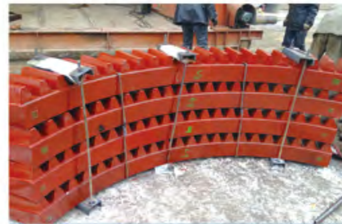
四分伞齿/ Bevel Gear M=36 \phi =8m
